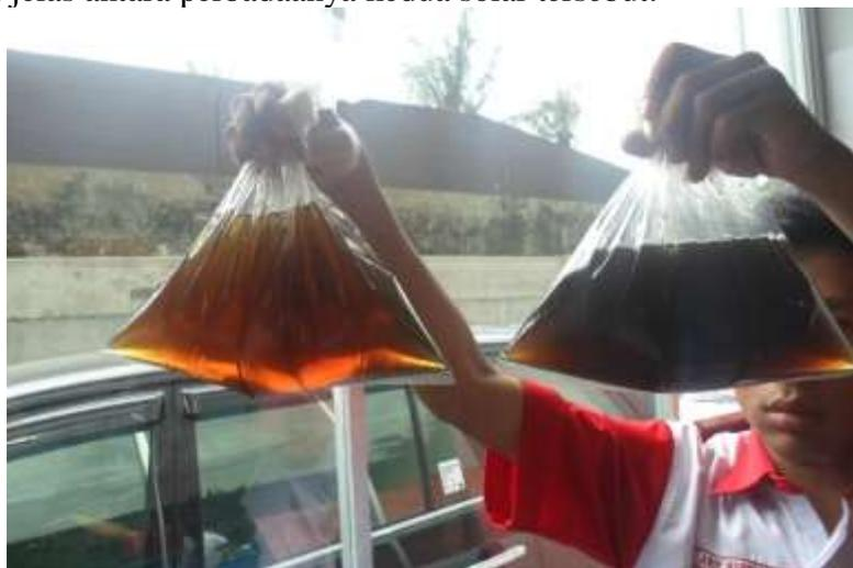
**Gambar 5.3 Perbedaan solar yang belum disaring dan sudah disaring**
